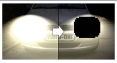
Wird der Sichtbereich der Kamera von Lichtquellen geblendet, werden diese Teile automatisch verdeckt, damit andere Teile nicht überblendet werden. Dies ist zum Beispiel hilfreich bei der Identifizierung von Kfz-Kennzeichen.
