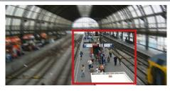
Unwichtige Bildbereiche können Sie mit reduzierter Qualität definieren. So sparen Sie Festplattenspeicher und Netzwerk-Bandbreite.
